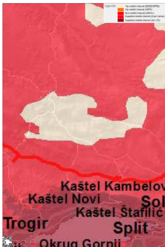
Slika 14: Pokrivenost 4G i 3G signalom HT-a (a, b) i Vipnet-a (c) [28], [8].
